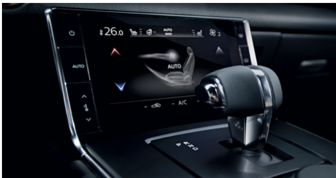
Écran secondaire tactile 7" pour réglages de la climatisation
