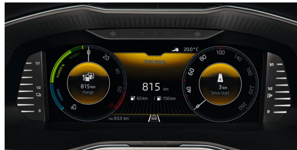
Affichage spécifique avec les jauges Power, Boost et Charge sur le Digital Cockpit
