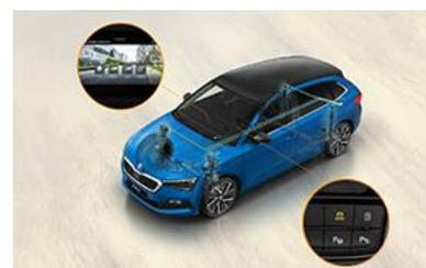
**Châssis Sport Select** : couplé à un rabaissement du véhicule de 15mm, le système offre au conducteur 2 lois d'amortissement : normal et sport. Le mode normal confère une plus grande stabilité que le châssis de série tout en restant confortable, tandis que le mode sport rend la suspension plus raide et le véhicule encore plus collé à la route.
