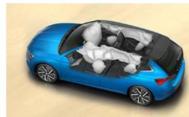
**Crew Protect Assist** : Réunissant 9 airbags pour une sécurité optimale en cas d'accident, le système peut aussi anticiper une situation d'urgence en rapprochant les ceintures de sécurité des passagers avant et en laissant les vitres ouvertes de 55mm pour limiter l'onde de choc provoquée par le déploiement des airbags.
