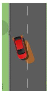
**Freinage anti multi-collisions** : En cas de collision, le système active les freins pour éviter ou atténuer une collision supplémentaire en réduisant de manière autonome la vitesse du véhicule. Dans ce cas, les feux de détresse et feux stop s'activent automatiquement.
