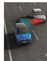
**Side Assist** : Si le système détecte un véhicule dans l'angle mort (portée de 70m), des LED s'illuminent sur le côté du rétroviseur extérieur et deviendra de plus en plus vif au fur et à mesure que le véhicule se rapprochera du vôtre. Actif dès 15 km/h
