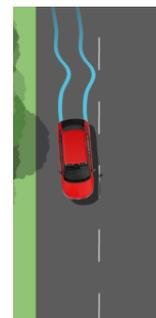
**Détecteur de fatigue** : En dessus de 65 km/h, les mouvements du conducteur sur le volant sont analysés en temps réel. Si le système détecte des comportements anormaux, une alerte s'affiche sur l'ordinateur de bord Maxi-Dot en recommandant d'effectuer une pause.
