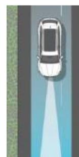
**Lane Assist** : Si votre véhicule s'approche trop du marquage latéral, une correction active de trajectoire s'effectue au niveau de la direction pour éviter tout risque de collision. Actif dès 65 km/h
