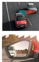
**Side Assist** : Si le système détecte un véhicule dans l'angle mort (portée de 70m), des LED s'illuminent sur le côté du rétroviseur extérieur et deviendra de plus en plus vif au fur et à mesure que le véhicule se rapprochera du vôtre. Actif dès 15 km/h
