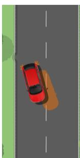
**Freinage anti multi-collisions** : En cas de collision, le système active les freins pour éviter ou atténuer une collision supplémentaire en réduisant de manière autonome la vitesse du véhicule. Dans ce cas, les feux de détresse et feux stop s'activent automatiquement.
