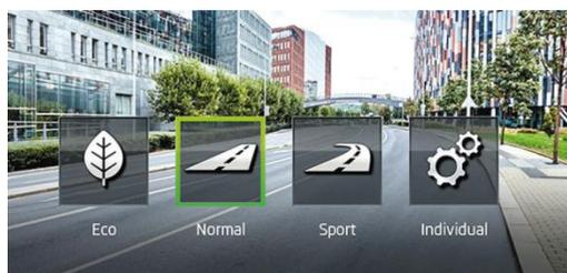
**Driving Mode Select** : Permet au conducteur de régler les paramètres de son véhicule selon 4 modes (éco, normal, sport et individual). Les réglages interviennent sur la réponse à l'accélérateur, les lois de passage de rapports (sur DSG), la dureté de la direction, le fonctionnement de l'ACC, etc.
