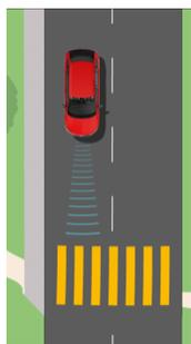
**Front Assist** : Préviens des dangers et des conséquences d'une collision avec le véhicule de devant. Dès que le véhicule se rapproche trop de celui de devant, une alerte sonore et visuelle apparaît. Dans certaines situations critiques, le système peut même amorcer le freinage.
