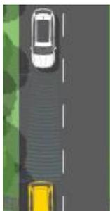
**Régulateur de vitesse adaptatif ACC** : Maintient une vitesse constante et calcule la distance avec le véhicule qui précède. La vitesse est ainsi constamment adaptée en fonction des conditions de circulation. Actif dès 30 km/h
