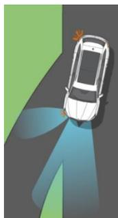
**Corner lights** : Aide à anticiper un obstacle lors d'un virage. En dessous de 40 km/h, la fonction éclairage d'angle s'active. Elle agit à droite ou à gauche selon l'allumage des clignotants et les mouvements du volant. Uniquement disponible avec projecteurs avant Full LED
