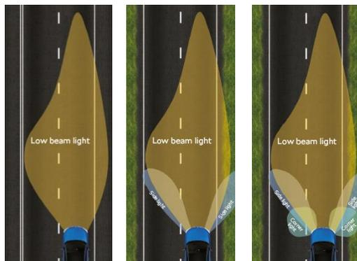
**AFS** : Adaptation du faisceau lumineux en fonction des conditions de circulation (ville, route, autoroute, mauvais temps). Le système agit sur la gestion de l'éclairage des feux de croisement.
