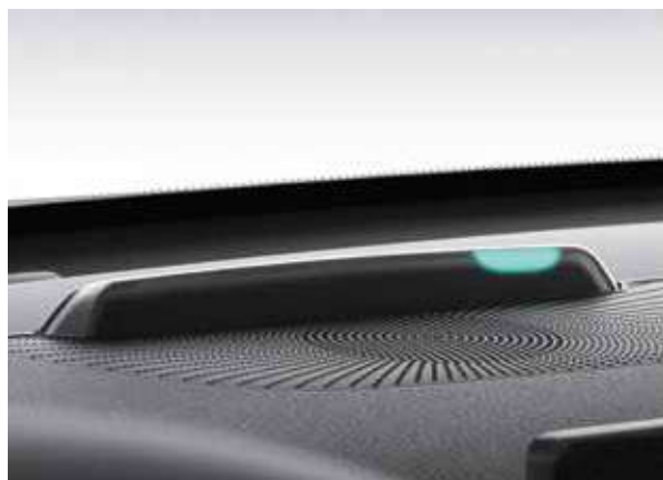
Indicateur de charge. Surveillez l'état de charge de votre véhicule grâce à un indicateur de charge des plus pratiques. Implanté dans la grille de haut-parleur au centre de la planche de bord et visible facilement même depuis l'extérieur du véhicule, cet indicateur à trois LED s'allume dès que vous branchez votre XCeed et vous indique l'état et le niveau de charge de la batterie.
